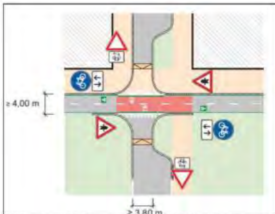
Bild 4-20: Bevorrechtigte Querung eines selbstständig geführten Radwegs über eine Erschließungsstraße (Beispiel RSV innerorts)
